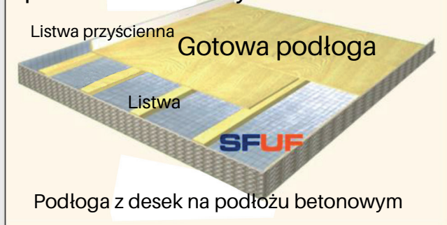
Podłoga z desek na podłożu betonowym
